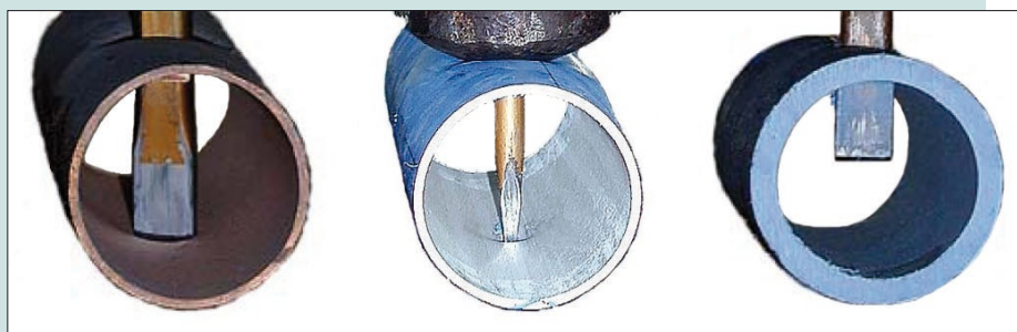
Kerbschlagzähigkeit von Druckluftrohren aus Kupfer, Aluminium und Kunststoff (von links nach rechts)
